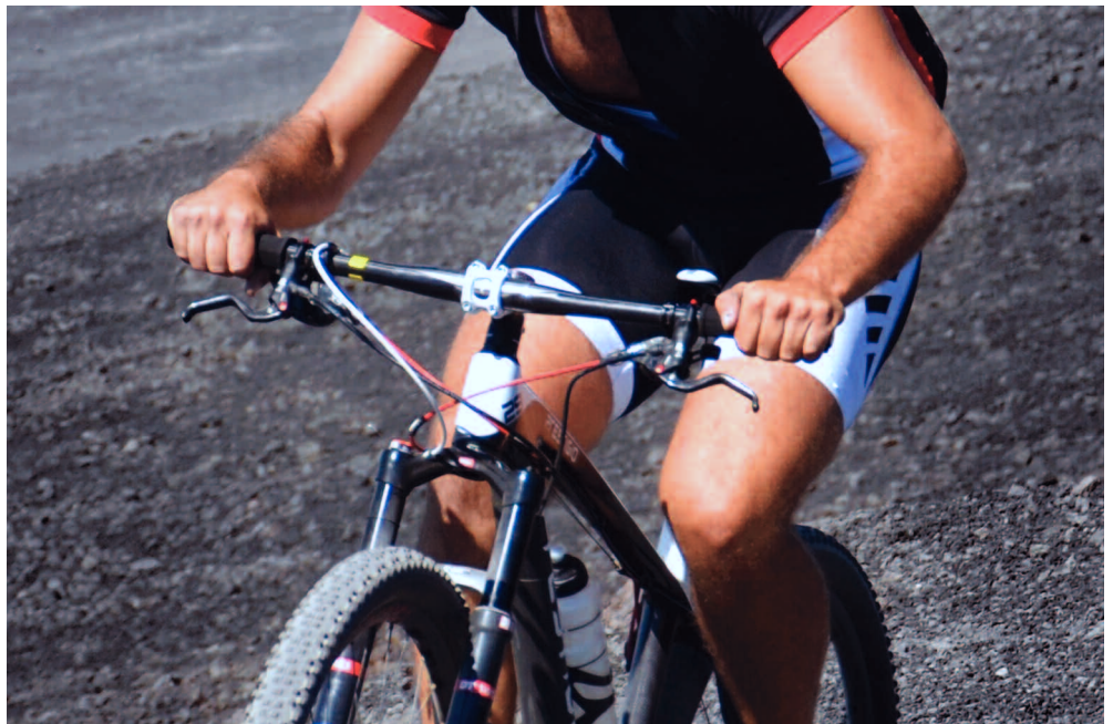
Il manubrio a "piega dritta" ha utilizzo predominante nell'ambito delle competizioni cross country.
