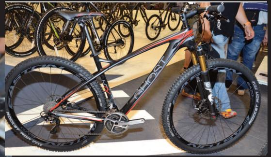
*Presentato in esclusiva da GHOST il nuovo sistema di sincronizzazione degli ammortizzatori a cura di Rock Shock. Il sistema si applica alle bici biammortizzate e funziona grazie ad un sensore applicato alla sospensione anteriore in continua comunicazione con la sospensione posteriore, che quindi si sbloccherà o irrigidirà in conseguenza dei segnali ricevuti durante il riding.*
