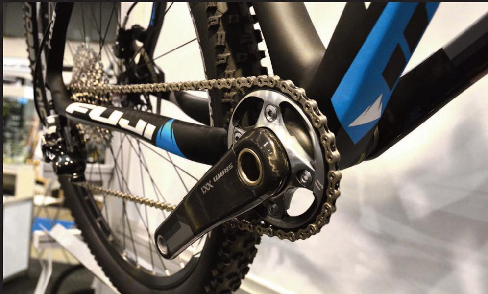
*Estrema ricerca di leggerezza e performance agonistiche di altissimo livello per questa FUJI 29 1.1: una sola corona da trenta denti per eliminare il peso del deragliatore e delle leve del cambio anteriore sul manubrio. Sul posteriore pignoni fino a 42 denti per pedalare anche sui dislivelli più ardui. Un prodotto dalla chiara vocazione race.*
